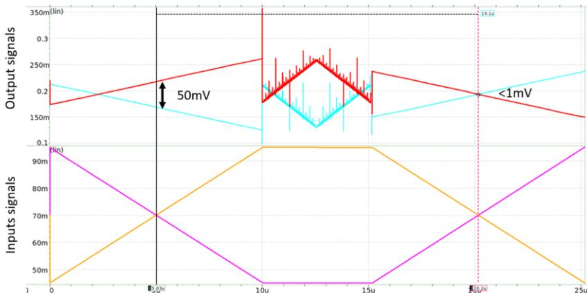
Рис. 7. Напряжение смещения до и после процесса калибровки
