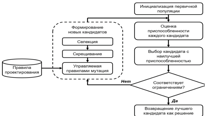
Рис. 2. Схема выполнения обновлённого ГА с управляемой мутацией
