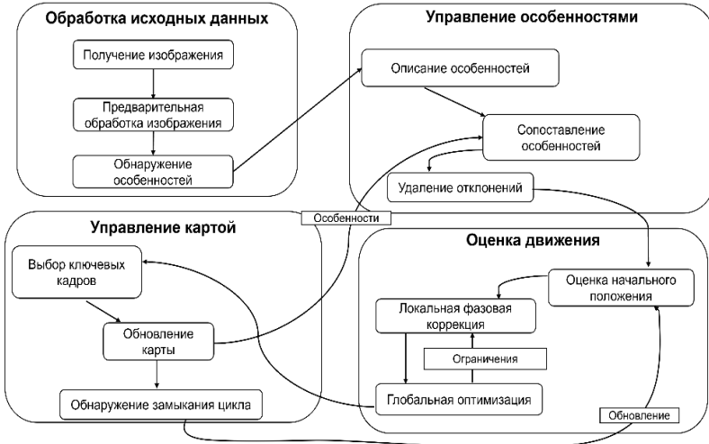
Рис. 1. Основная структура и поток данных системы признакового метода ВО
